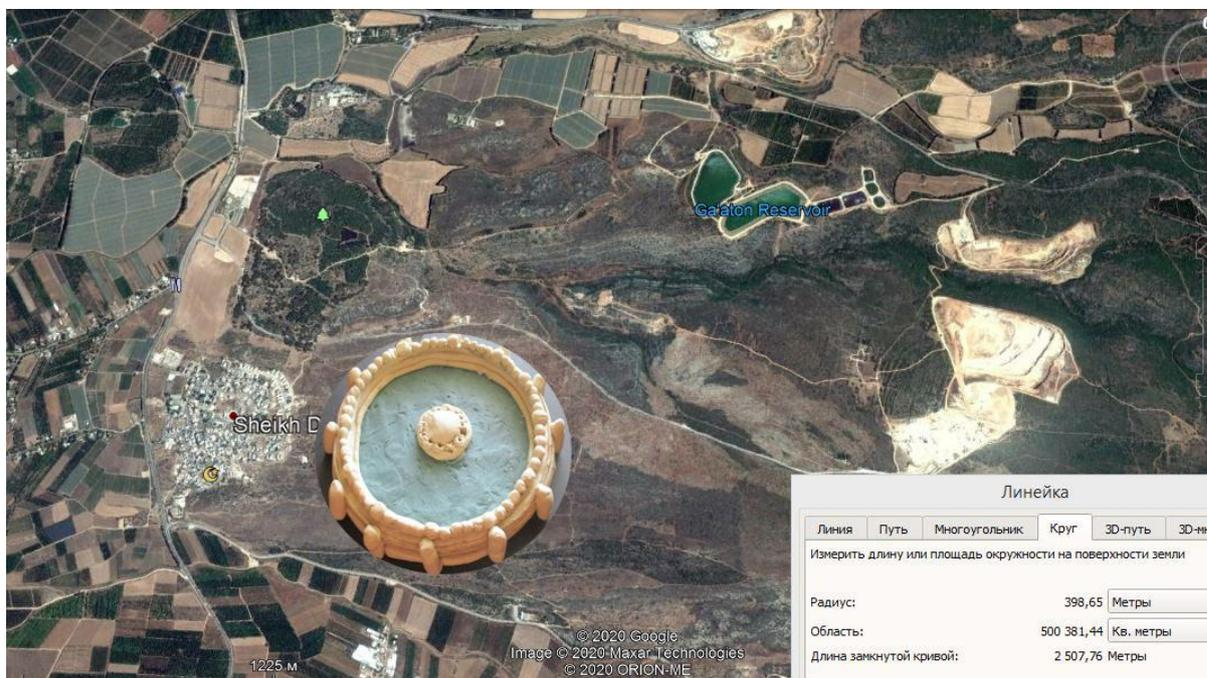
Рис.2 Верхний водоем ГАЭС-2 у Шейх-Данун, 500 МВт, диаметр 800 м, с городом вокруг него (идея арх. А. Ноткин)
